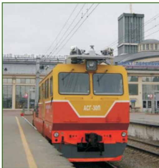
Рис. 1 Мобильная сканирующая система, установленная на моторсе
